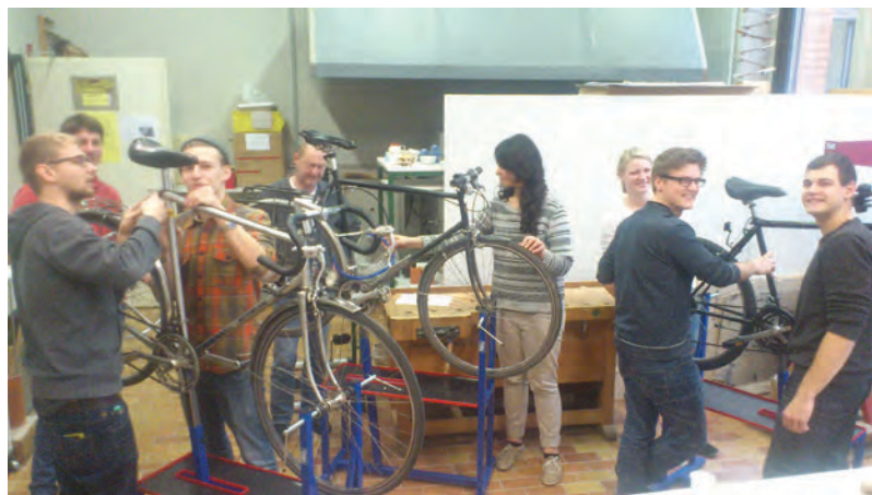
Drei Werkstattböcke bilden drei Arbeitszonen, an denen gleichzeitig montiert werden kann. Bild: C. Wiesmüller
